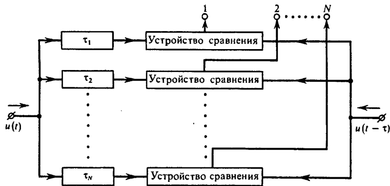
Рис. 3.3. Устройство для измерения времени задержки сигналов
