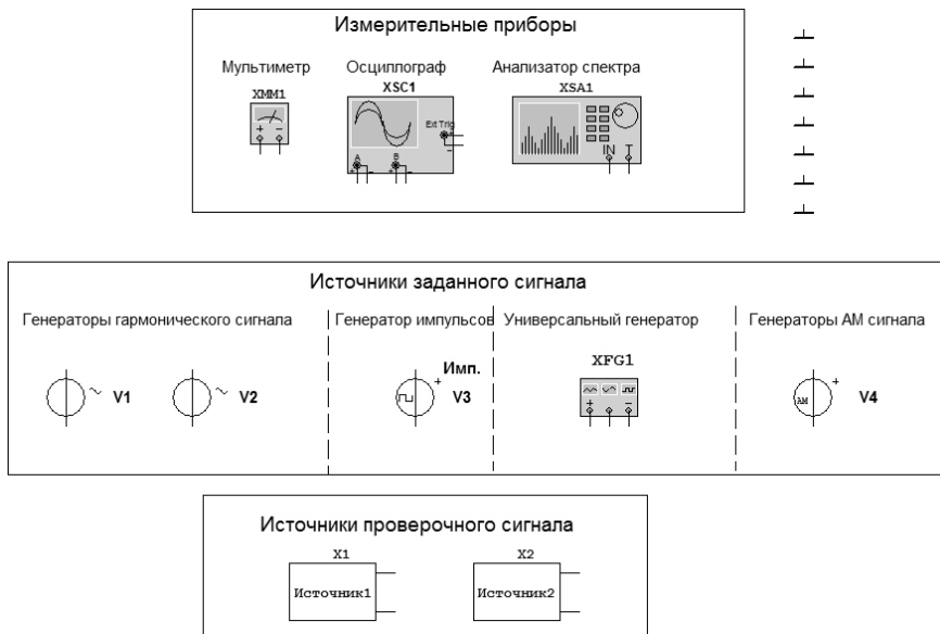
Рис. 1.3. Схема лабораторного макета
